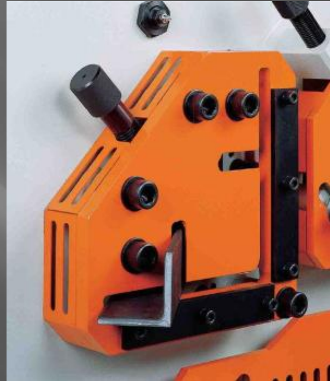
Slika 5.42 Operacije sečenja kombinovanim makazama a) sečenje kvadratne šipke, b) sečenje L-profila pod uglom
