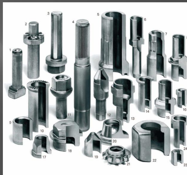
Slika 5.28 Delovi proizvedeni na višepozicionom automatu, Hatebur AKP 4-6 S [46, 63]
