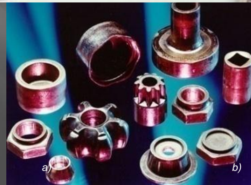
Slika 5.16 Delovi oblikovani hladnim istiskivanjem na presi Gräbener MMK [51] a) asortiman delova, b) faze istiskivanja
