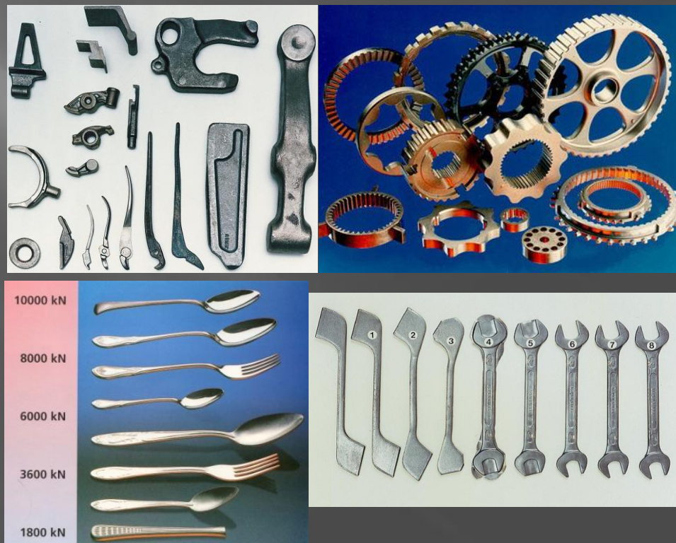
Slika 5.23 Delovi kalibrisani ili oblikovani na presi za kalibrisanje, Schuler [10]
