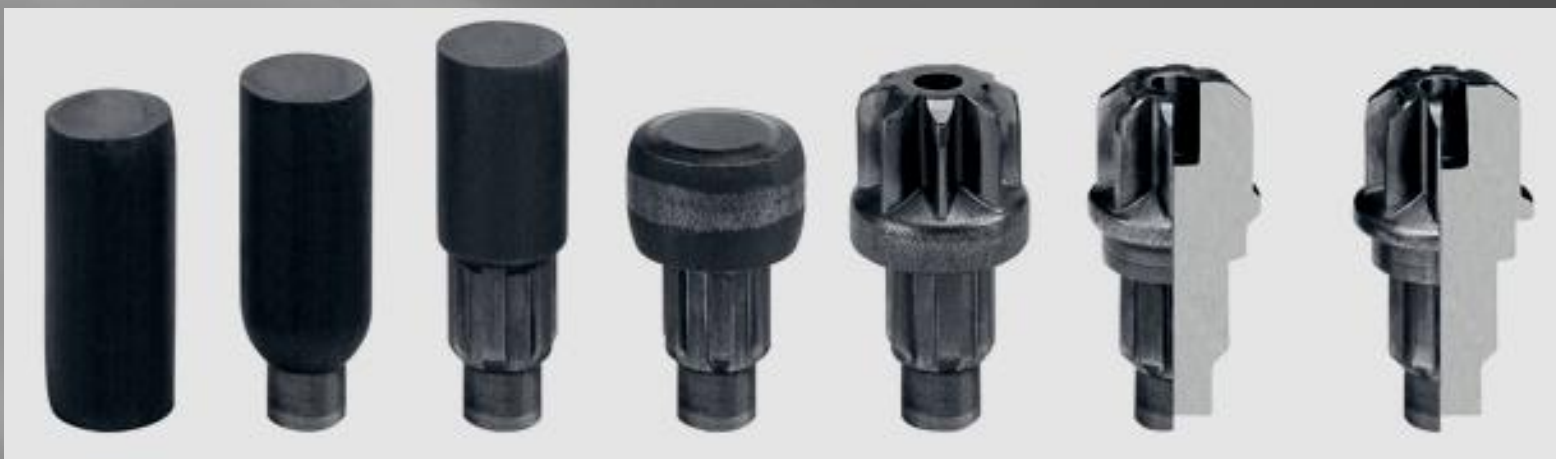
Slika 5.31 Faze oblikovanja zupčanika na šestopozicionom automatu AKP 4-6 S, Hatebur [63]
