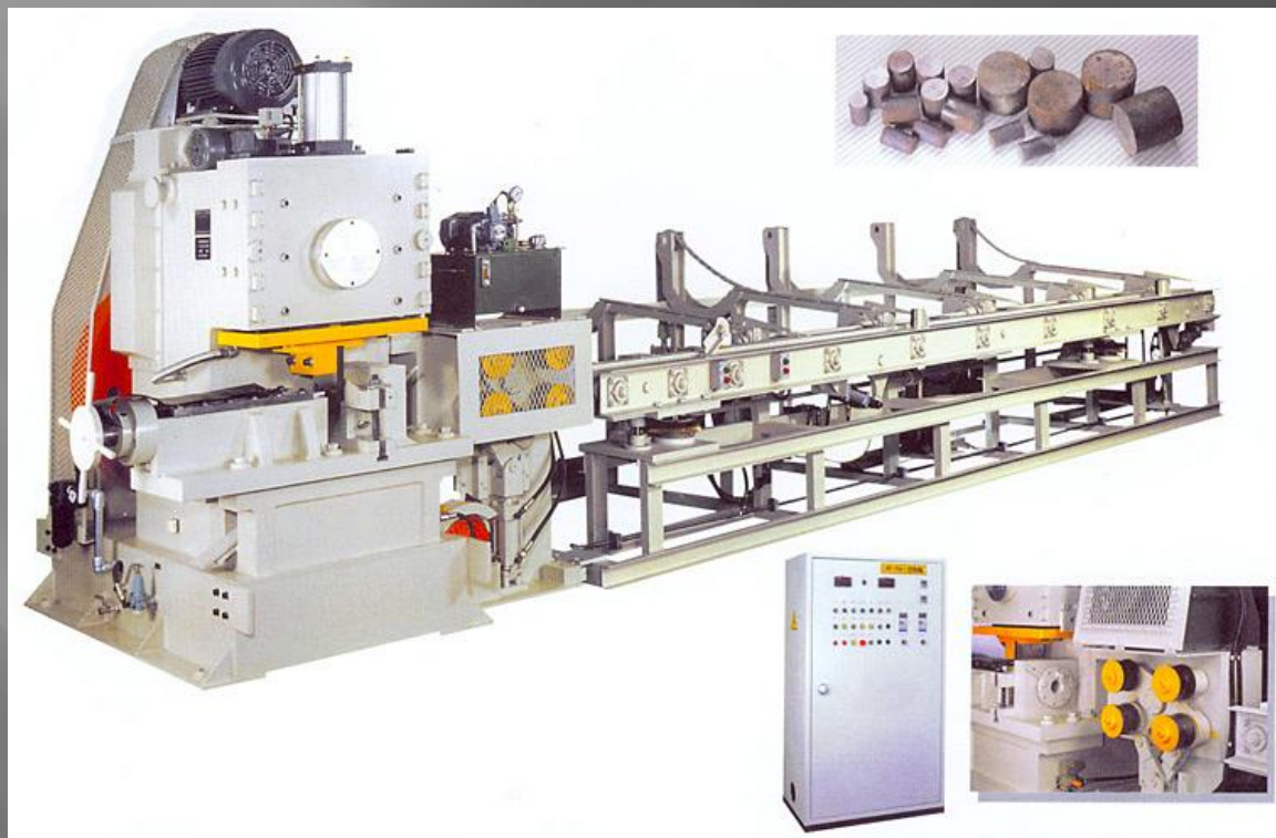
Slika 5.39 Linija za odsecanje pripremake prečnika od 30 mm do 100 mm [80]
