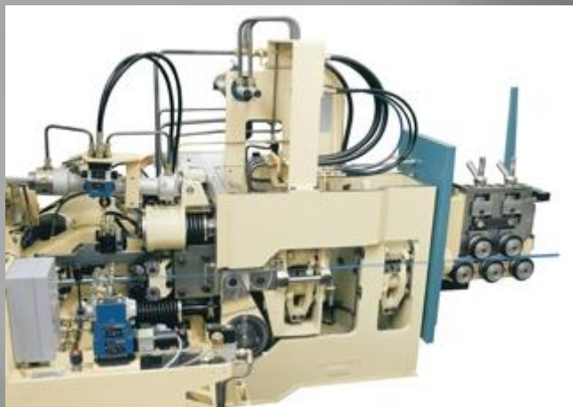
Slika 5.32 Uređaj za dodavanje materijala, Hatebur [63]
